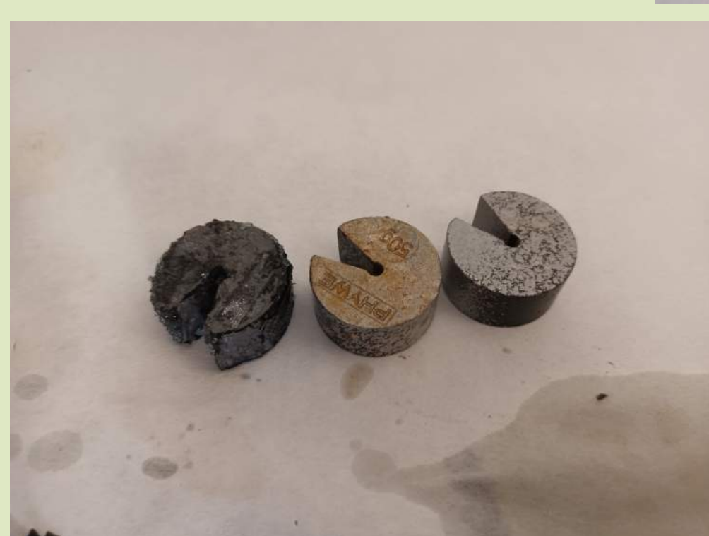
Figura 3. Piezas de metal pintadas después de sumergirlas varios días en agua destilada, Coca Cola y ácido sulfúrico 2M.
