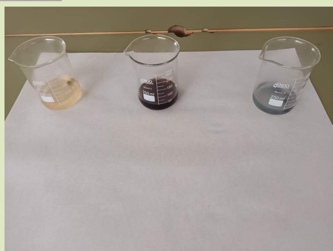
Figura 2. Bolas de acero sumergidas en agua destilada, Coca Cola y ácido sulfúrico 2M.
