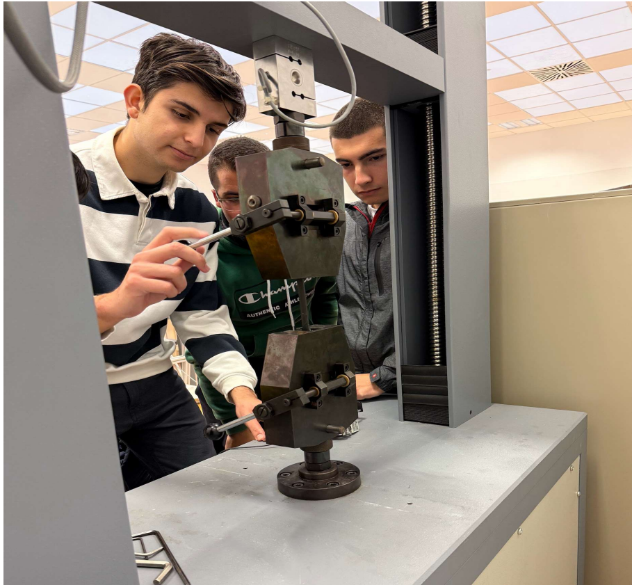
Figura 11. Ensayos de tracción de las probetas impresas en 3D
