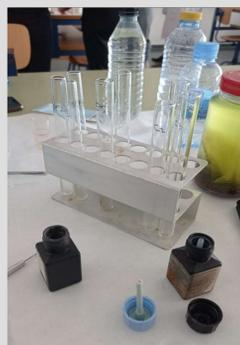
Imagen 1: Materiales utilizados. Se puede observar gradillas, tubos de ensayo, tipos de agua y reactivos para determinar el nitrato.
